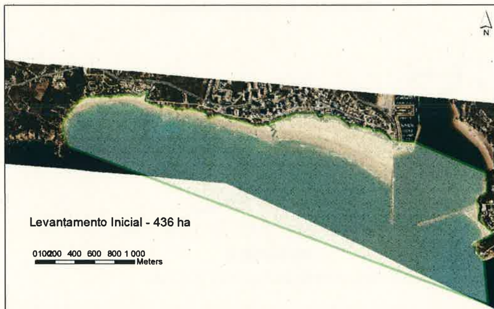
Figura 18 – Implantação da área (436 hectares) a submeter a levantamento topohidrográfico inicial no âmbito da presente empreitada. Coordenadas ETRS 89-PT-TM06
